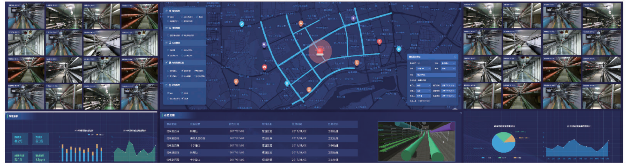
> 实现对廊体的实时监控、视频侦测、环境分析、应急处置，对处置进行记录，并对处置记录、结果进行分析
